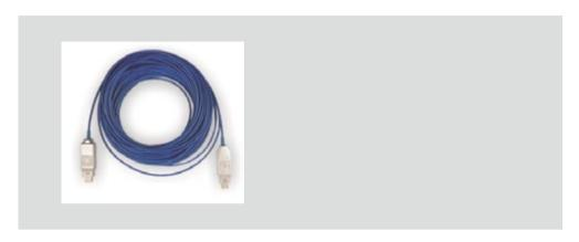
长芯盛 FbC 系列产品是业界首款 1394b 有源光纤数据线。采用光纤取代铜线作为传输介质,极大地扩展了 1394b 的传输距离。在不增加任何中继设备的情况下,最大传输距离将超过 500 米。此款产品完全兼容 1394b 规范,可直接替代原有的 1394b 9-Pin 铜线,其中主机端不需要供电,设备端需要外接电源。
