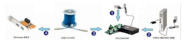
第一步:为 EPU3H01AR 接配套的电源适配器;
