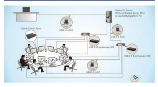
云终端系统解决方案包括:云终端、USB3.0 有源光缆和高速集线器。基于 USB 3.0 的云终端系统可将当前 480Mbps 带宽拓展 10 倍至 5Gbps。采用 USB3.0 有源光缆可将客户端与 主机之间的距离从 5 米拓展至 100 米,从而解除了基于传统 USB 传输的多点系统的距离限制,拓宽了商业及工业环境下的相关应用。同时,高速集线器保证了每个 USB 2.0 设备均可达到最大带宽 480 Mbps,而不必与其他设备共享带宽。
