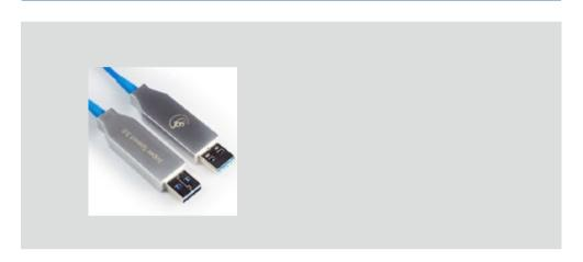
为了弥补普通 USB3.0 有源光纤数据线无法给设备供电的缺陷,长芯盛推出了新一代的 USB3.0 有源混合光纤数据线(U3HC)。在采用光纤作为传输介质的基础上,集成铜缆以达到给设备供电的目的。目前在不增加任何中继设备的情况下,混合光缆长度可达 50 米,非常适用于不具备现场供电能力的应用场合。此款产品完全兼容 USB3.0 规范,内置独特的 SuperTT 技术能够对 USB3.0 和 USB2.0 的协议进行互相转换,从而使 USB2.0 设备共享 USB3.0 的高速带宽(5Gbps)。在搭配 USB 集线器使用时,可以让多个 USB2.0 设备独享 480Mbps 的峰值带宽。
