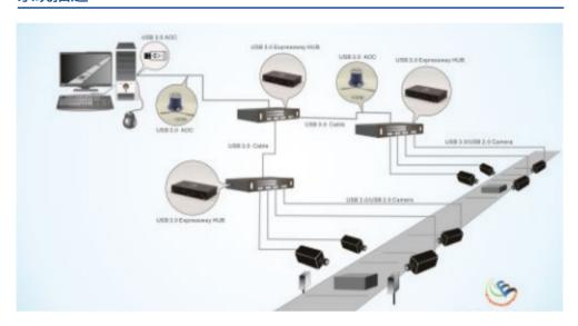
长芯盛公司的 USB3.0 有源光纤数据线和具有 SuperTT 技术的 USB3.0 扩展集线器为机器 视觉客户提供了一种卓越的数据传输解决方案。长芯盛 USB3.0 传输解决方案配合有源光缆 技术成功地将铜缆传输距离(小于3米)扩展到100米以上。这种解决方案极大地促进了 USB3.0 接口在更大的范围内的使用。
